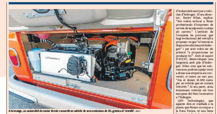
A la imatge, un automòbil de motor tèrmic convertit en vehicle de zero emissions de CO 2 gràcies al 'retrofit'. ANU
