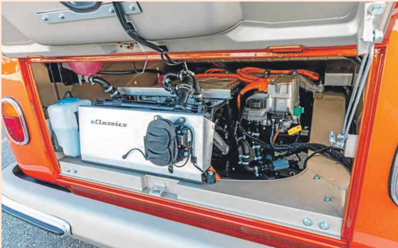
A la imatge, un automòbil de motor tèrmic convertit en vehicle de zero emissions de CO 2 gràcies al 'retrofit'. ARXIU
